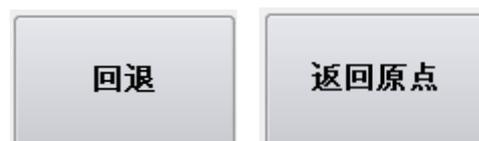
急停后再按“F8 返回原点”键，割炬以直线距离用移动速返回本次切割的起始点，即起始段的开始。
