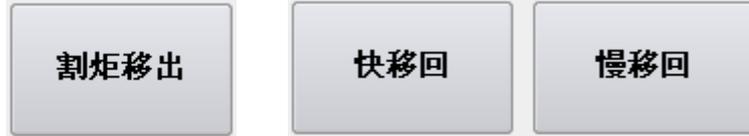
的红色圆圈可以知道割炬移动时的具体位置。按“F1 快移回”，割炬以空走速度快速移回原来的位置；按“F2 慢移回”，割炬以切割速度慢速移回原来的位置。主要有二种情况下需要将割炬移位：
