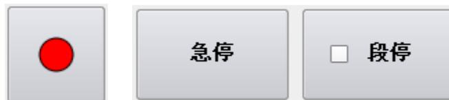
此按钮只有在加工模式菜单里存在，一旦退出加工模式菜单，此按钮将不起作用。面板下方大方向键中的黄色急停按钮在任何界面下都起作用，无论用户正在进行任何操作，例如编辑文件，导入 U 盘或者零件套料等，只要按下黄色急停键，系统立刻停止加工。
